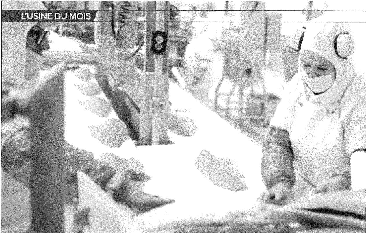
**PARAGE** Le site transforme uniquement des filets de saumon frais jusqu'à 1,9 kg, prélevés « pre rigor » dans les abattoirs norvégiens, ou bien dans le site que Mowi exploite à Boulogne-sur-Mer, pour les origines Ecosse et Irlande. Une fois orientés sur la ligne, les filets sont désarêtés puis pelés automatiquement. Les peaux et les coproduits sont valorisés en petfood.
